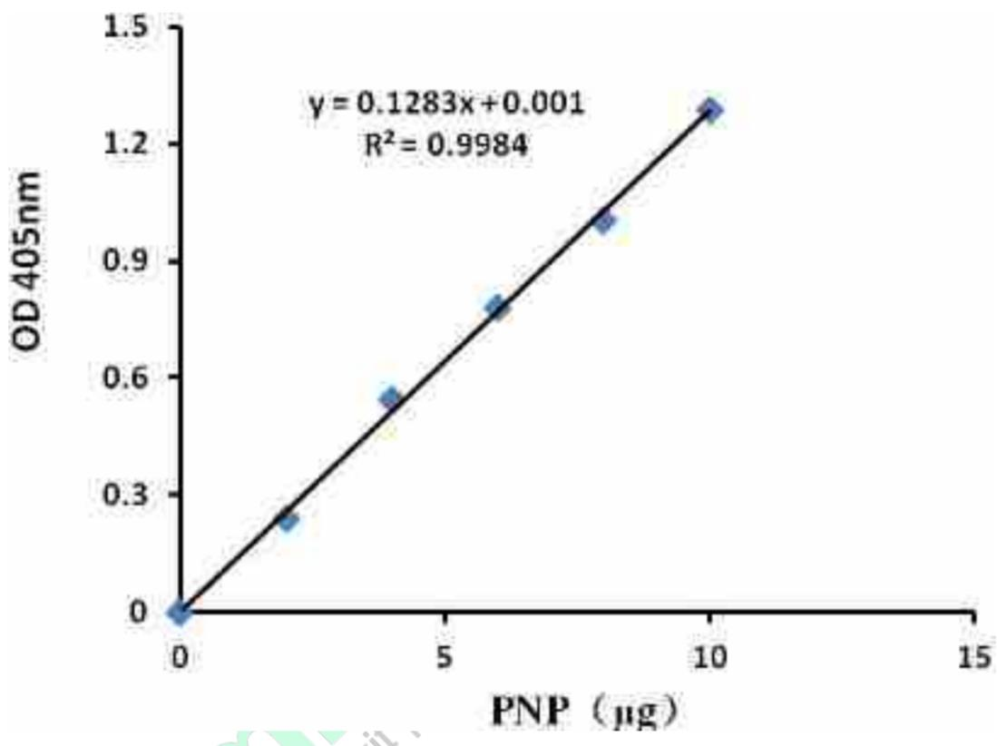
2、活性定义：在  $37^{\circ}\text{C}$ , 每小时每克土壤产生  $1\mu\text{g}$  对-硝基苯酚 (PNP) 定义为 1 个酶活单位。 $S-\alpha\text{-Afa}(\mu\text{g}/\text{h/g 土样}) = [({}^{\Delta}\text{A}-0.001) \div 0.1283] \div W \div T \times D = 7.8 \times ({}^{\Delta}\text{A}-0.001) \div WD$
